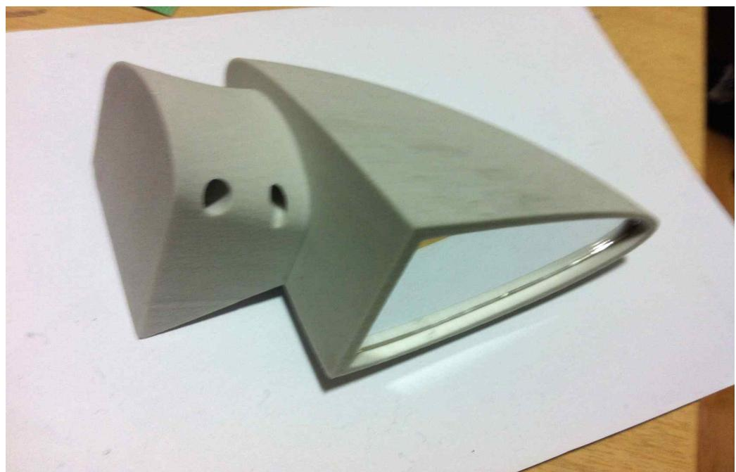
(그림 3-11. 3D도면을 이용하여 3D프린터 제작한 제품의 배출구 모습)
