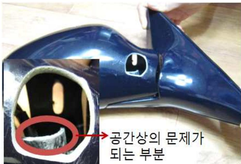
(그림4-14)와 같이 최초 제작된 프로토타입에 유체관이 설치 될 수 없었던 결정적인 원인을 표시하였다. 위 그림에서 원으로 표시된 부분으로 인하여, 실제 설치된 프로토타입의 유체관의 치수는 줄어들 수밖에 없었다.
