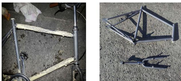
Fig. 3.4 프레임 페인트 리무버 작업
