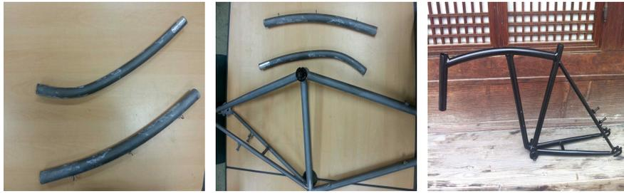
Fig. 3.5 프레임 절단 및 용접작업
