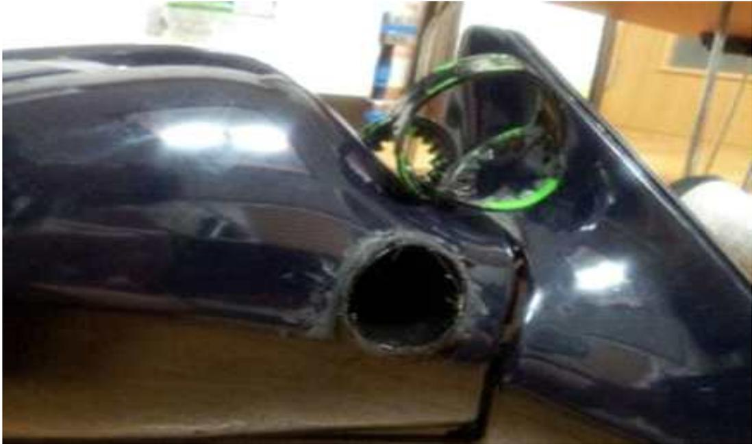
(그림 3-28. 보조유체관의 고정장치 유입구 모습)
