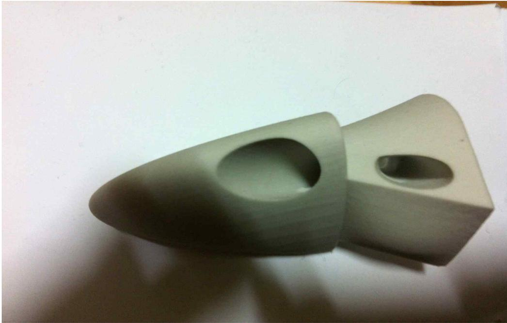
(그림 3-10. 3D도면을 이용하여 3D프린터 제작한 제품의 유입구 모습)
