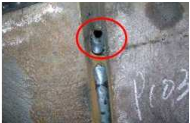
[그림 2-16] 폐 책걸상을 이용한 프레임 제작: 용접 불량
