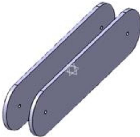
〈그림 2-10〉 설계 변경된 붐(Boom) 형상
